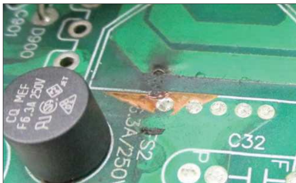
Obr. 1. Porucha zařízení el. obloukem v důsledku usazeného prachu
